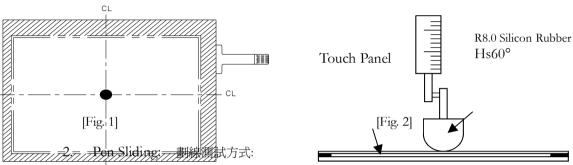
⑤ Test Position: Center of Active Area, 40mm×40mm. (Fig 3) 測試位置: 動作區的中心點 40mm×40mm.(圖3)
